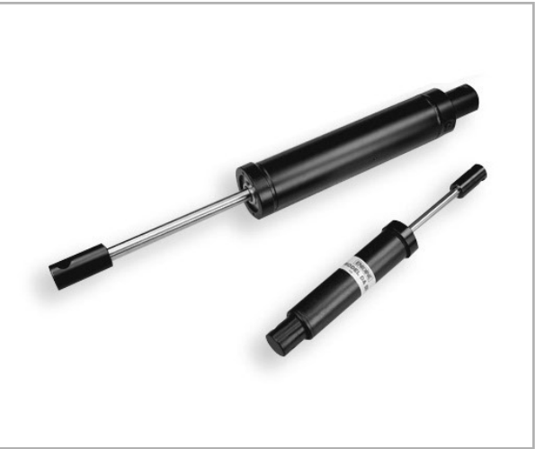
DA Series DA 75×50 ~ DA 75×250 압축 또는 신장 그리고 압축과 신장으로 댐핑방향 선택가능 스트로크 전반에 걸쳐 일정한 댐핑효과 주문자 생산사양의 비조정형 모델
